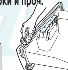
Прокладка вакуумного отделения Паз для крепления прокладки вакуумного отделения
